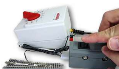
Weichenanschluss an Trafos anderer Hersteller (hier: Märklin®)
