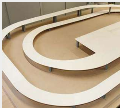
5. Die Gleistrasse ist nun fertig montiert.
