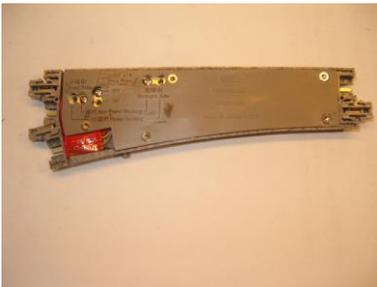
Nachdem alle Anschlüsse auf Sicherheit, keine Verbindungen untereinander, geprüft ist die Weiche ordnungsgemäß wieder mit dem Deckel verschließen und die Weiche ist für den digitalen Betrieb bereit
