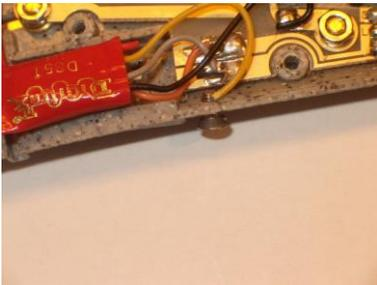
Am Gleiskörper eine Senkschraube M2 von Außen anbringen. Mit 1,8mm vorbohren, das gelbe Kabel ablängen und ein kurzes, abisoliertes von Innen bis zur Kabelisolierung in das Loch stecken.
