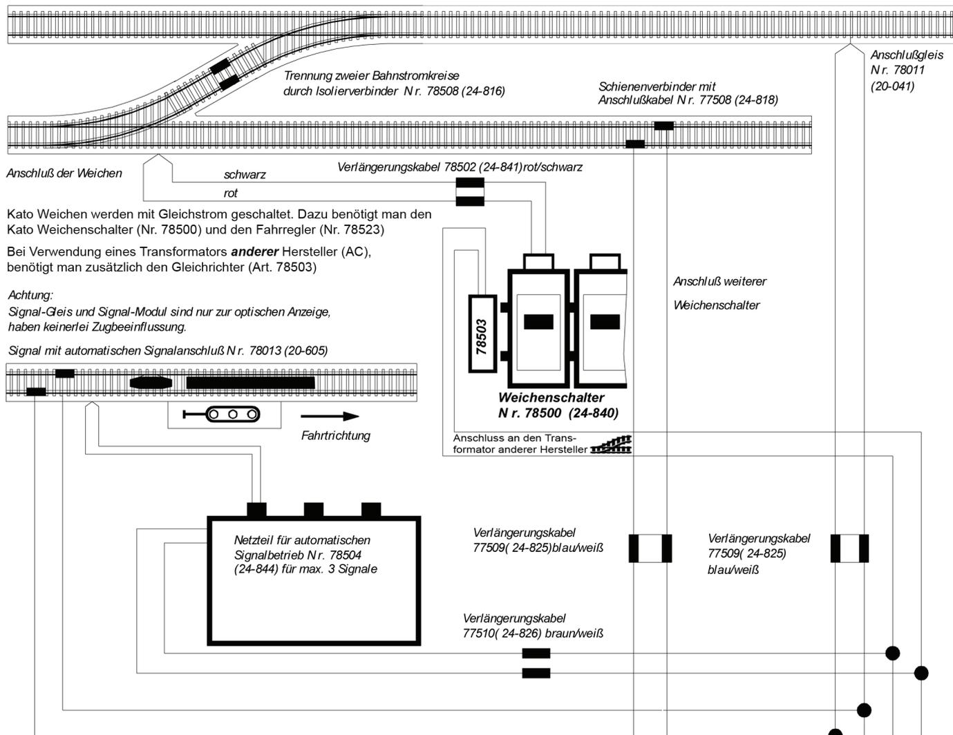
Zur Verlängerung der Weichen-Signale und Anschlusskabel können vorgefertigte Kato Verlängerungen mit den entsprechenden Normsteckern verwendet werden.
